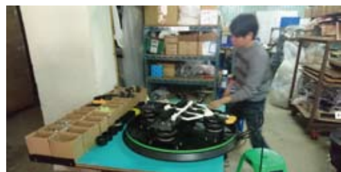
モーションベースのエアバッグ設置作業
